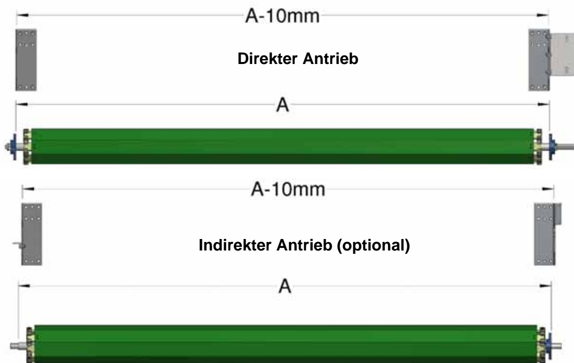
Abbildung 5b, Montage des vormontierten Torbandes
