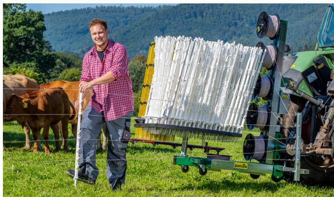
Verwisselbaar magazijn voor maximaal 400 palen
