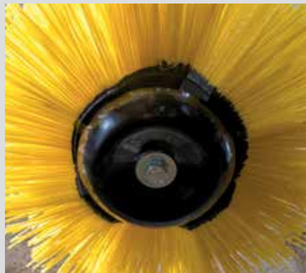
Spannscheibe zum sicheren Fixieren der Bürstenscheiben auf dem Korpus
